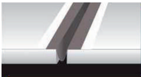
Umiestnenie pásky Mapeband PE120 v tvare \Omega v mieste dilatlačnej škáry.
